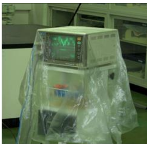
شکل ۲- پوشاندن تجهیزات موجود در ناحیه آلوده اورژانس پرتوی با پوشش‌های نایلونی
